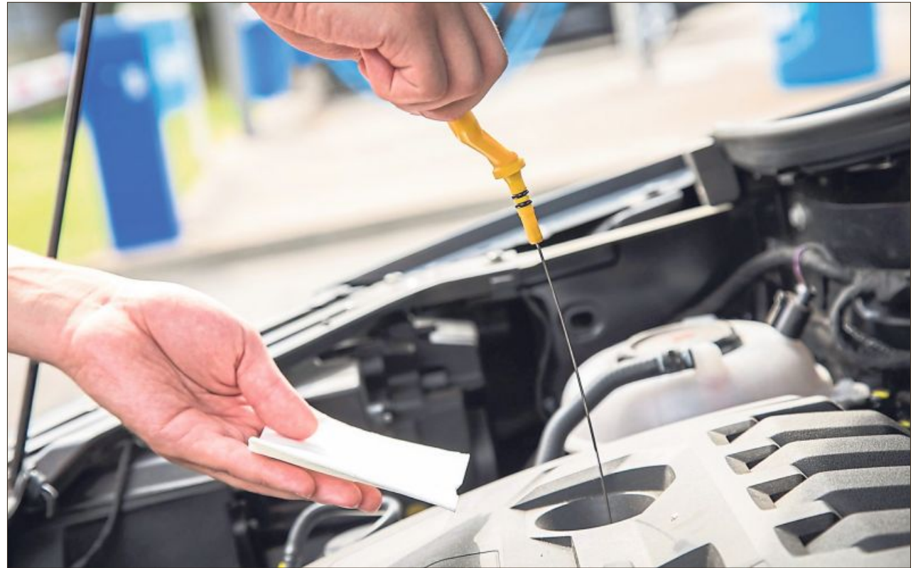
Die regelmäßige Kontrolle des Ölstands alle 1.000 Kilometer kann vor Motorschäden schützen. Foto: Christin Klose/dpa-tmn
