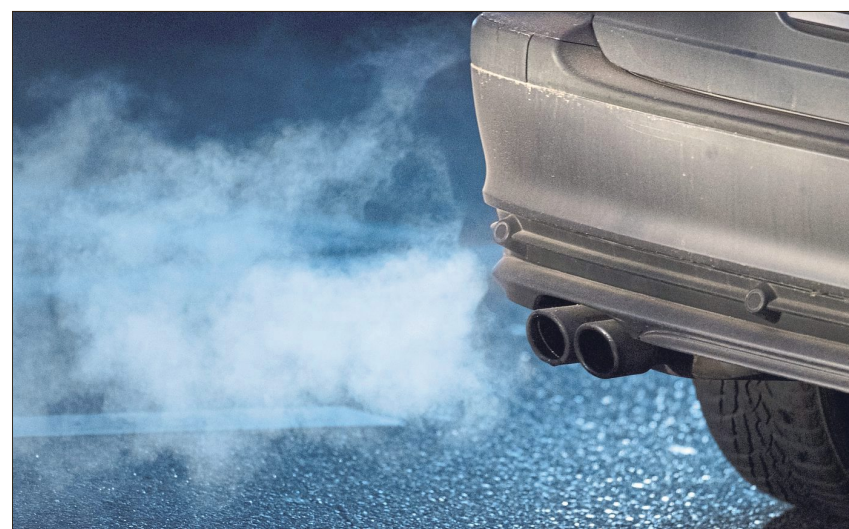
Blau, weiß oder schwarz: Auffälliger Auspuffrauch kann auf verschiedene Defekte hinweisen.
